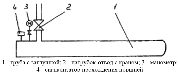
Рисунок 13 - Принципиальная схема камеры приема поршней и загрязнений при продувке
